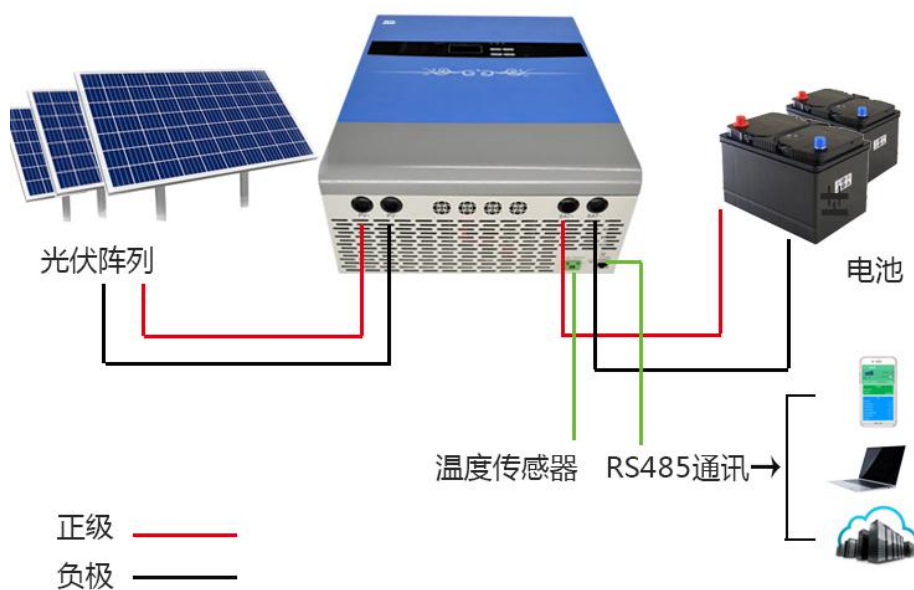
图 3-2JN-HV 系列 MPPT 控制器接线图
